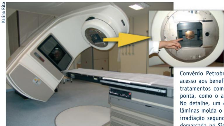
Convênio Petrobras/Uerj dá acesso aos beneficiários a tratamentos com tecnologia de ponta, como o acelerador linear. No detalhe, um conjunto de lâminas molda o feixe de irradiação segundo a área demarcada no Sistema Varis.
